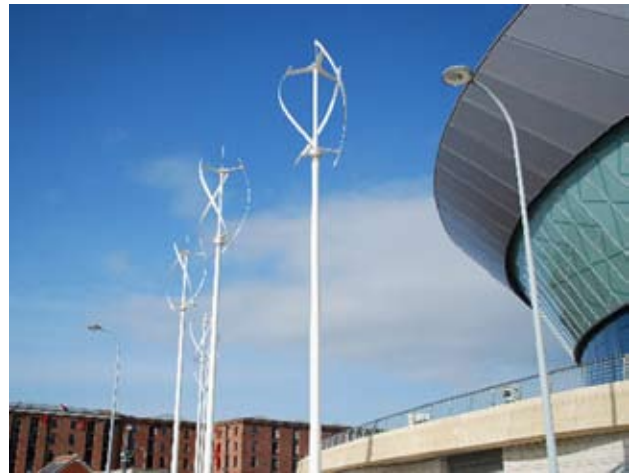
Vertikalakslede vindturbiner utenfor et konferansesenter i Liverpool.
