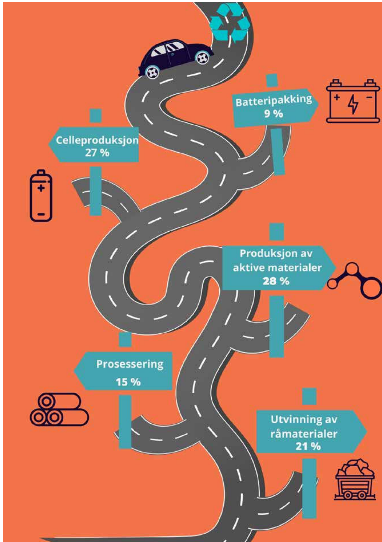
Figur 5. En forenklet versjon av verdikjeden til et batteri. Viser verdikjede fra råmaterialer utvinnes i gruvene og frem til batteriet går til gjenbruk eller resirkulering. Prosentene viser hvor stor andel av det totale utslippet de forskjellige prosessene står for. Basert på en beregning av World Economic Forum, Global Battery Alliance og McKinsey. 30 Det understreker viktigheten av å ta ansvar i hele verdikjeden.
