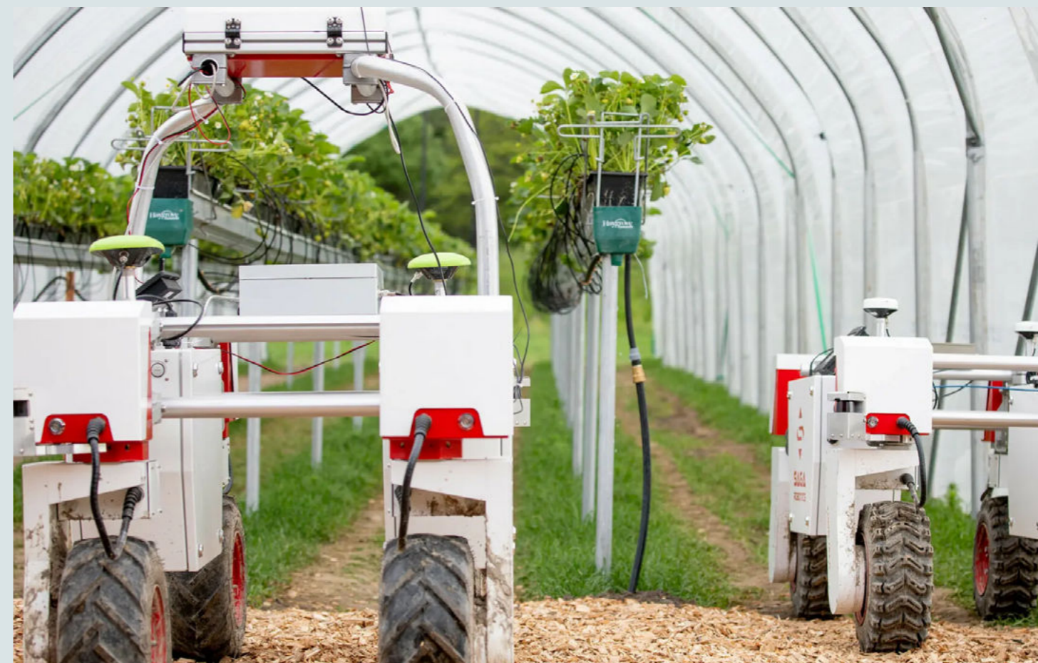
Den norskutviklede landbruksroboten Thorvald er eksempel på teknologi som kan effektivisere grønnsaksproduksjon og kutte utslipp ved å erstatte dieseldrevne maskiner. Foto: Håkon Sparre/NMBU
